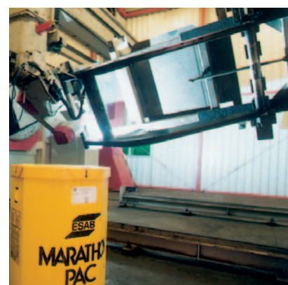
Schweißen von Erdbewegungsmaschinen am Roboter.
